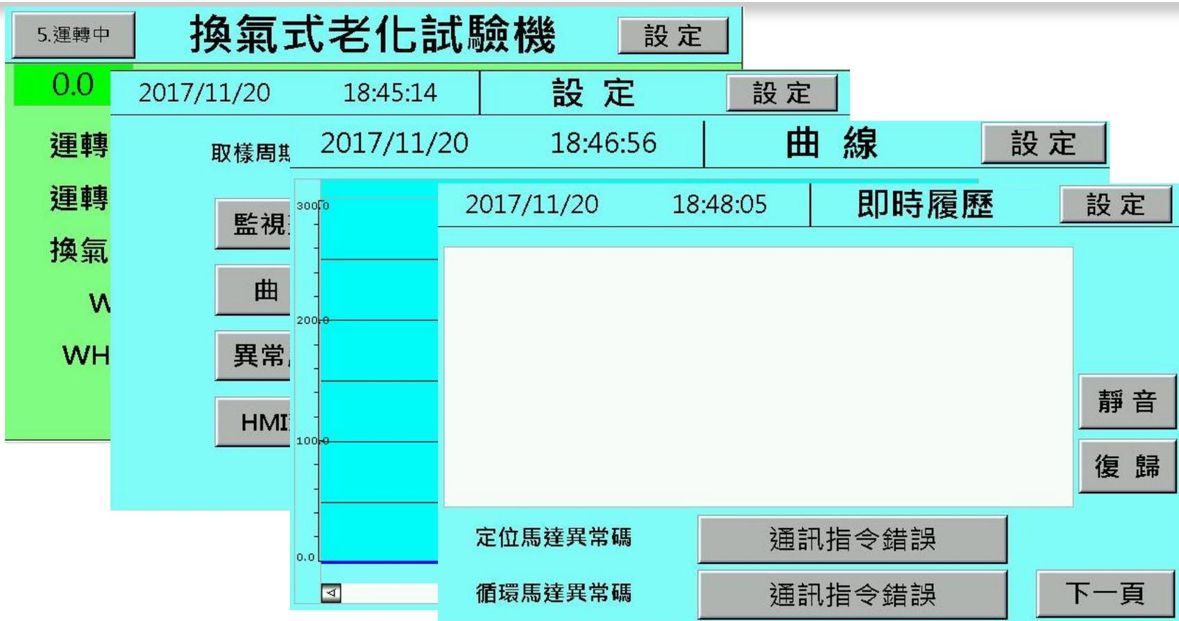
彩色LCD觸控螢幕，人機設定顯示直接輸入溫度值、換氣次數、運轉時間，本系統自動化程序控制，全自動換氣系統，(不須人員耗時去計算換氣量與調整換氣閥)。
